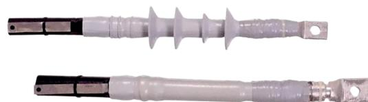
Las terminales QTII permiten en un solo paso el control de esfuerzo, protección mediante aisladores de caucho de silicona contra descarga superficial y sello contra humedad.
