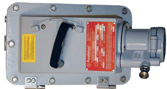
Estas tomas Industriales a prueba de explosión y a prueba de polvo cuentan con un interruptor o con un breaker y un enclavamiento que evita que la clavija tipo ACP pueda ser enchufada o desenchufada en posición de encendido asegurando que no haya posibilidad de que se produzca una chispa o un arco. Están disponibles para 30, 60, 100 y 150 Amp. Este modelo específico cuenta con Breaker EHD de 100Amp a 480Vac y una toma de esta misma capacidad y conexiones de 3 Alambres 4 Polos.
