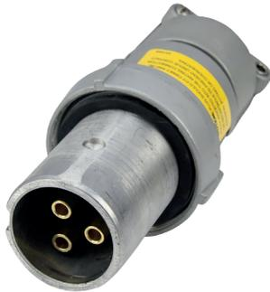
Estas clavijas tipo PIN & SLEEVE se pueden usar tanto en tomas industriales para áreas sanas tipo Powertite como en tomas para áreas clasificadas como las FSQC, las EBR/EBRH, las JBR y las ASR e incluso con tomas de otros fabricantes compatibles. Esta clavija tiene una capacidad de 100 Amp a 600 Vac, 3 Alambres 4 Polos y puede usarse con las tomas ADR1034, ARC1034CD, FSQC61040 y EBR1034EH100 entre otras.
